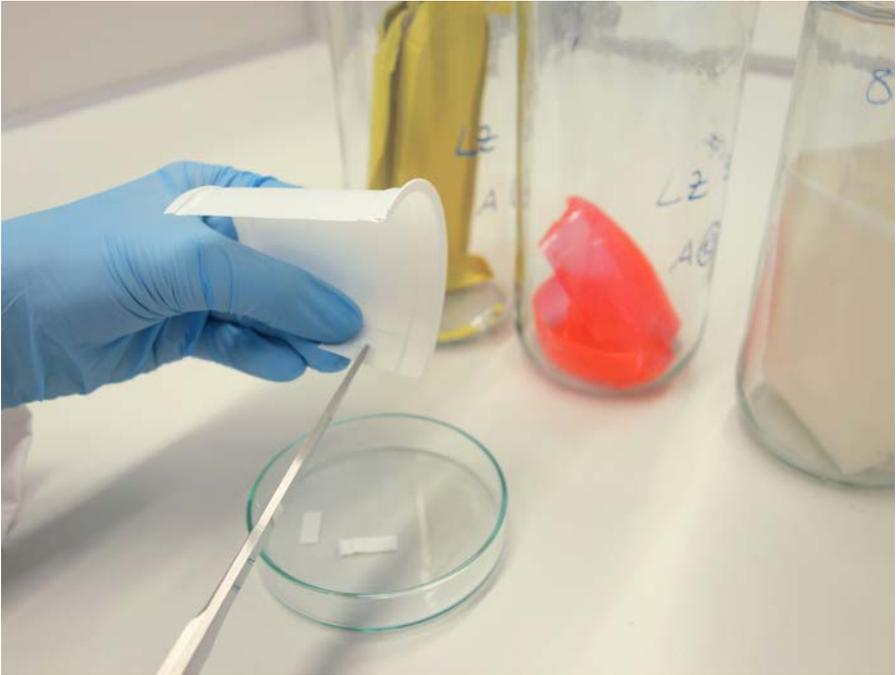
Bild oben: Schneiden der Plastikprodukte für die anschließende Extraktion
