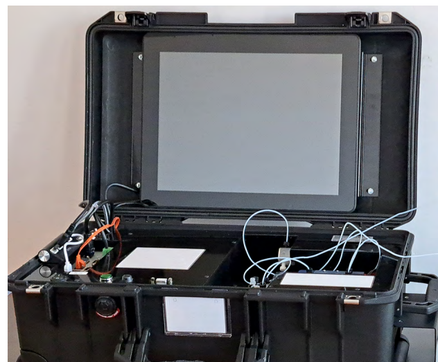
Abb. 3: Illustration der mobilen Nutzungsmöglichkeit des Ecoplas-Messsystems in einem Koffer (Bild: ECH)
