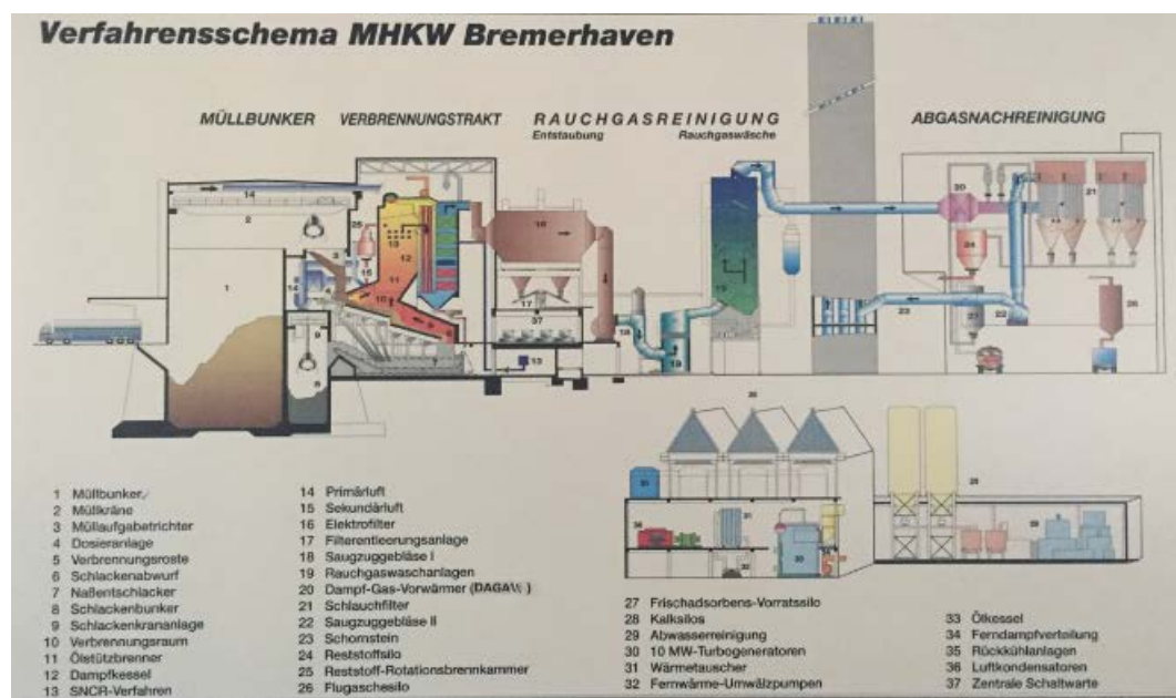
Abbildung 49: Verfahrensschema des Müllheizkraftwerkes der BEG
